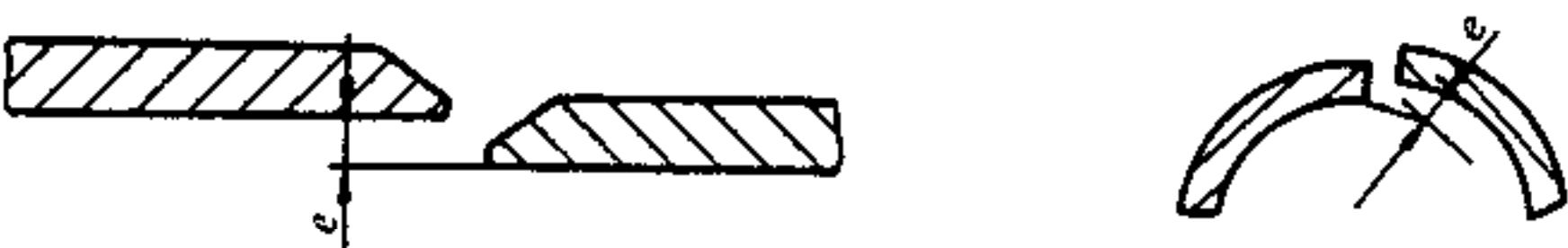
图 1 筒体合缝边的错动 e
